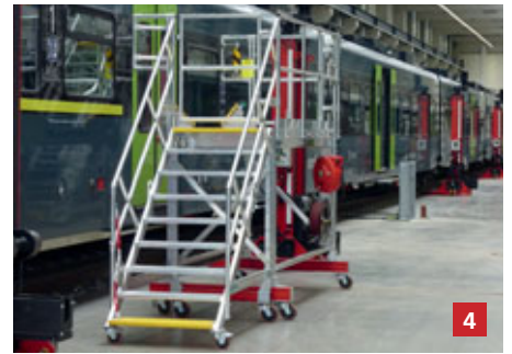
4. Mobile Seitenarbeitsbühne zum Bearbeiten der unteren Seitenbereiche
