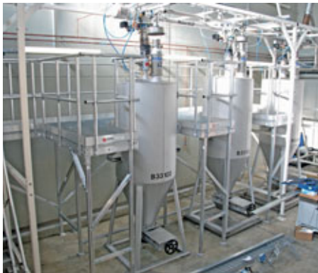
Fachmännische Konstruktionen mit genauen Konturanpassungen für gefahrloses Arbeiten in der Höhe
