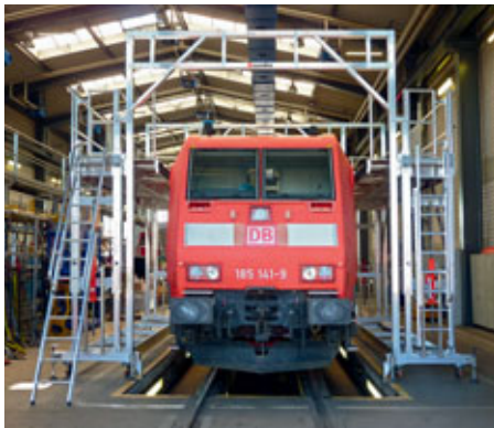
Mobile Dacharbeitsbühne mit Höhenverstellung – für komfortable und schnelle Instandsetzungen
