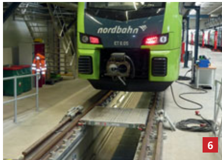
6. Gleisplatten, 2 Stück zum sicheren Überqueren der Gleisruten
